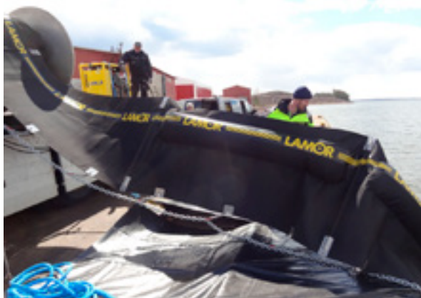
Barrera de neopreno, altura: 1650 mm (65 pulgadas)
