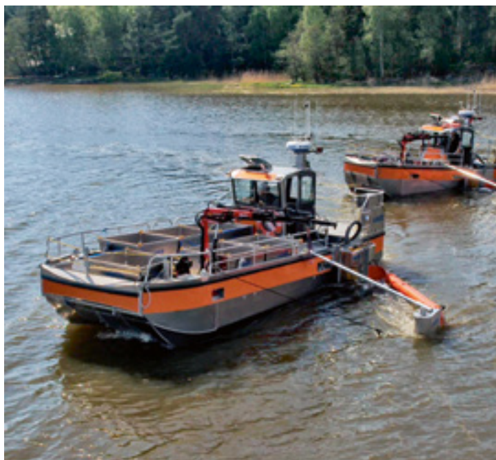
Embarcación de trabajo de calado ultrabajo equipada con casete lateral para la recuperación de petróleo
