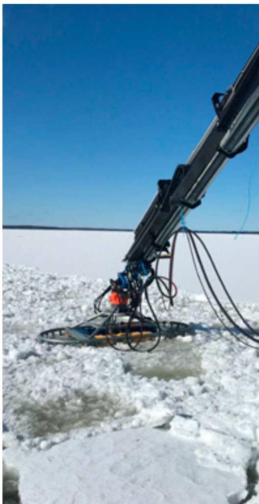
Sternmax 10, capacidad: 50 m 3 /h (220 gpm)
