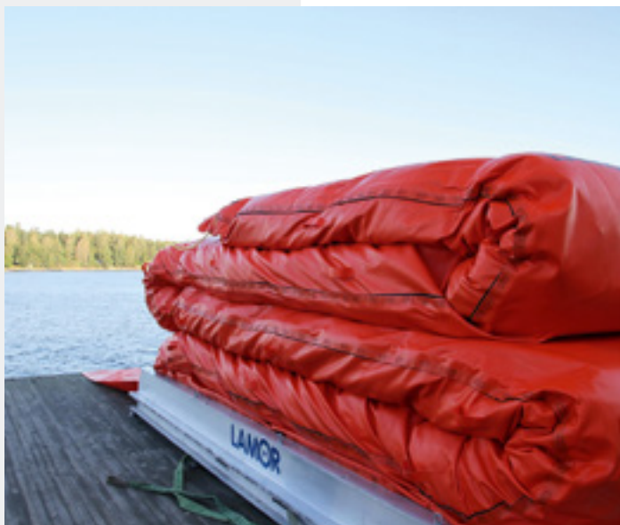
Paquete para barrera FOB de despliegue rápido sobre plataforma de almacenamiento/transporte
