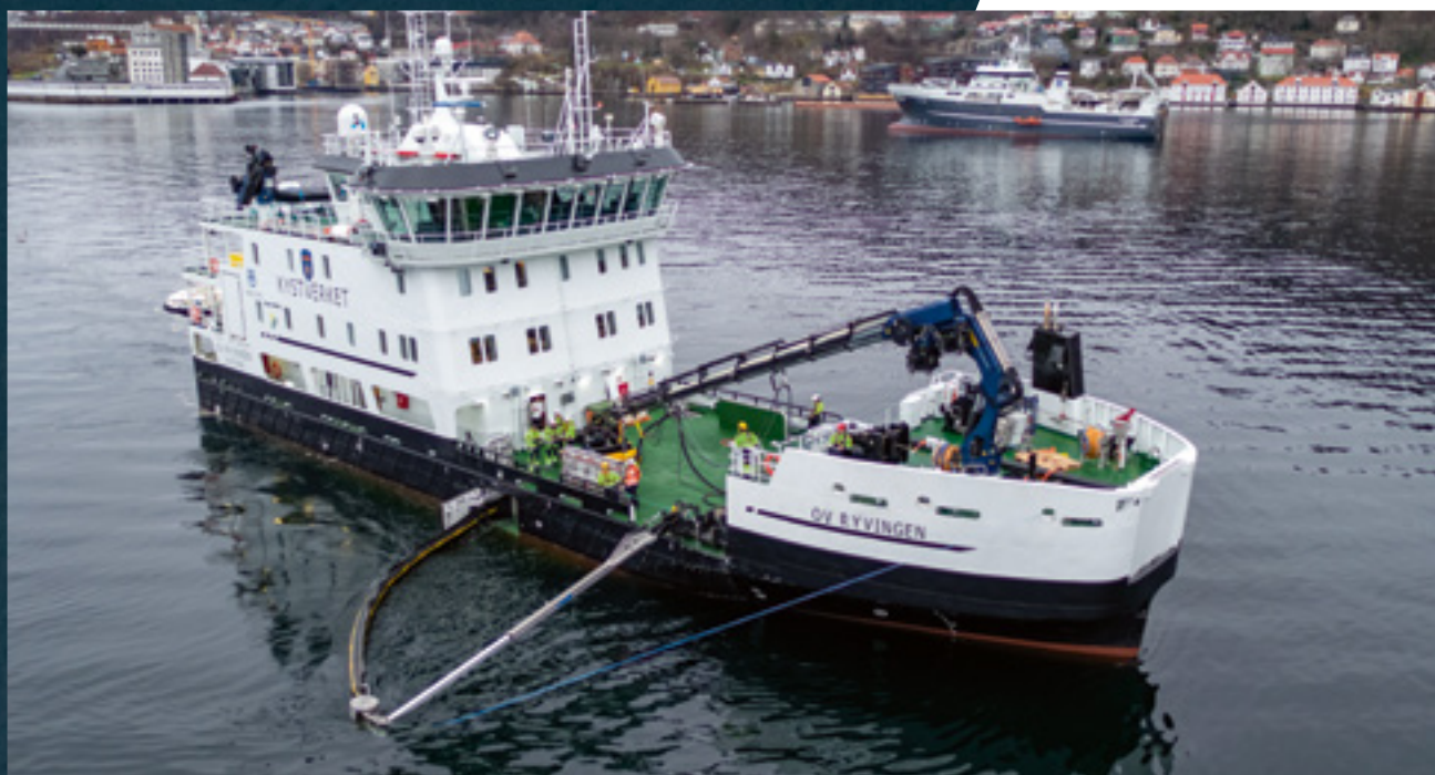
Sistema de recolección de Hidrocarburos
