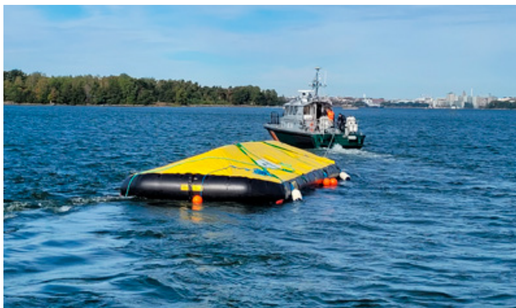
Barcaza para almacenamiento de petróleo
