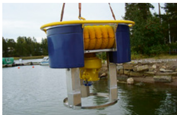
Multiskimmer (LMS 50/70), capacidad: 271.5 m 3 /h (1,195 gpm)
