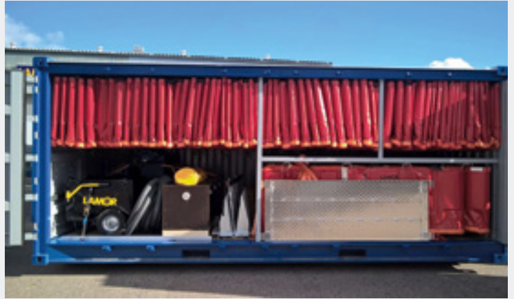
Barreras FOB almacenadas en estanterías, dentro de un contene-
