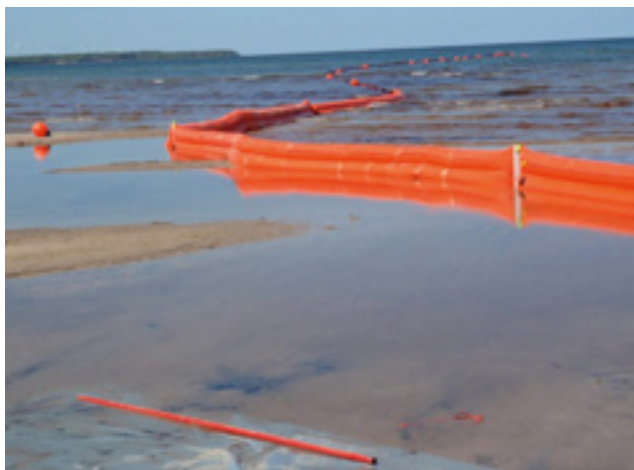
Barrera para sellado de playas, altura: 550 mm (22 pulg.)
