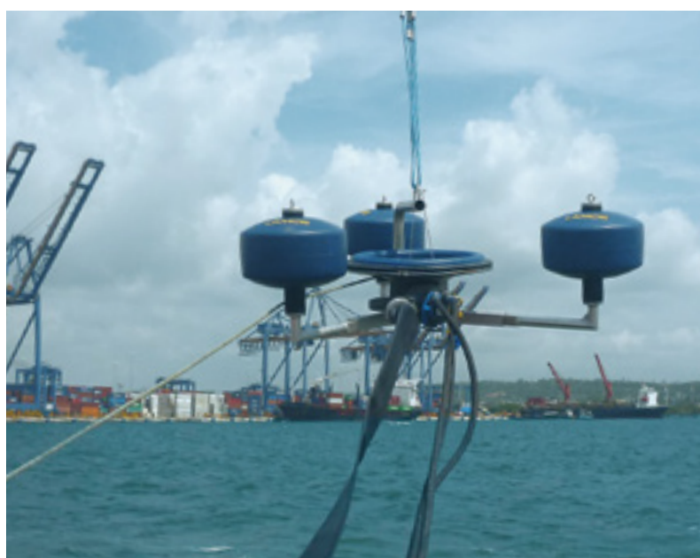
Skimmer de Vertedero 800 (LWS 800) capacidad: 112.2 m 3 /h (494 gpm)
