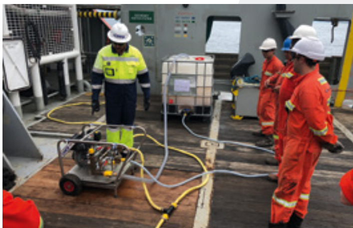
Sistema de dispersante Lamor - Eléctrico LDS 50-200
