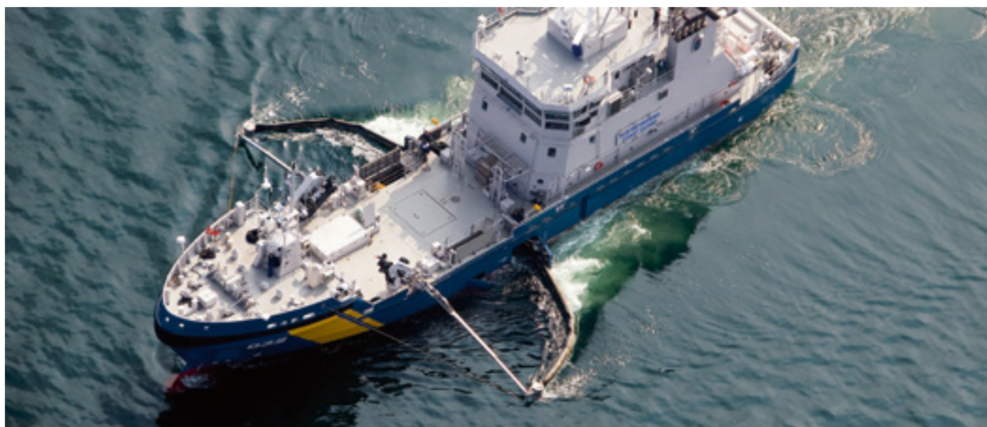
Sistema integrado para recolección de hidrocarburo (LORS)
