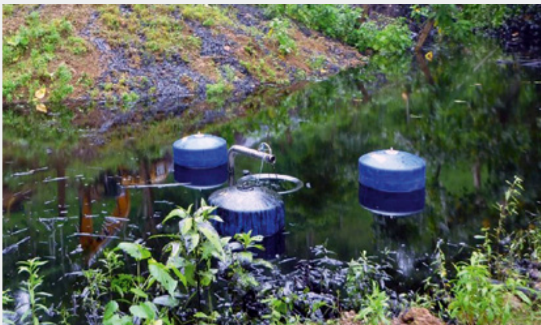
Skimmer de vertedero 500, capacidad: 70 m 3 /h (308 gpm)
