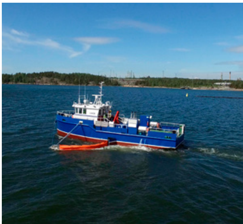
Sistema de recuperación de casete
