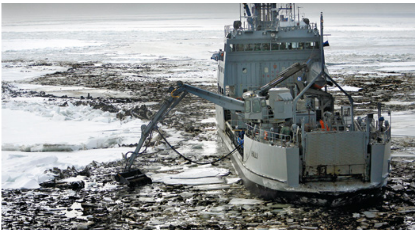
Skimmer de recuperación (LRB 250), capacidad: 140 m 3 /h (616 gpm)
