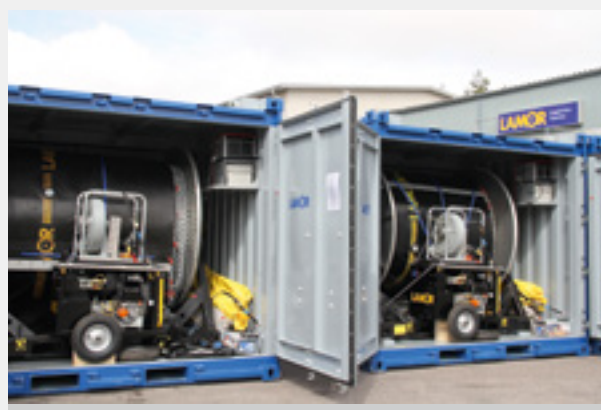
Solución en contenedor para barrera petrolera de alta resistencia HDB 1500
