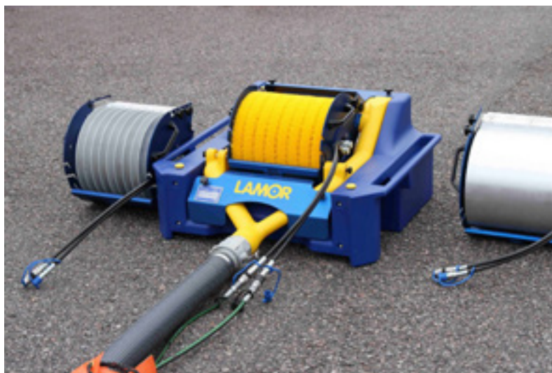
Minimax 25 (MM 25), capacidad: 25 m 3 /h (110 gpm)
