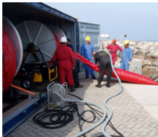
Barrera ligera inflable (PVC/PU y neopreno) altura: 650-1650 mm (26-65 pulgadas)
