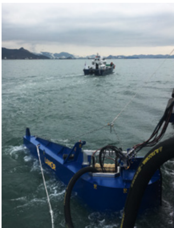
Sistemas de barrido rígido (LSS)
