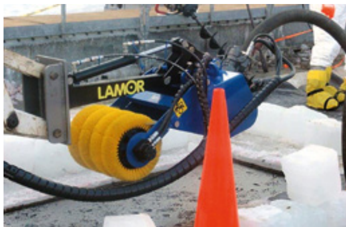
Skimmer de recuperación Lamor 40 (LRB 40) capacidad: 19 m 3 /h (83 gpm)
