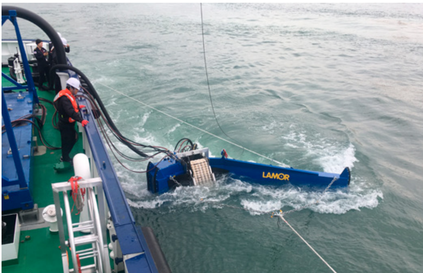
Sistemas de barrido rígido (LSS)
