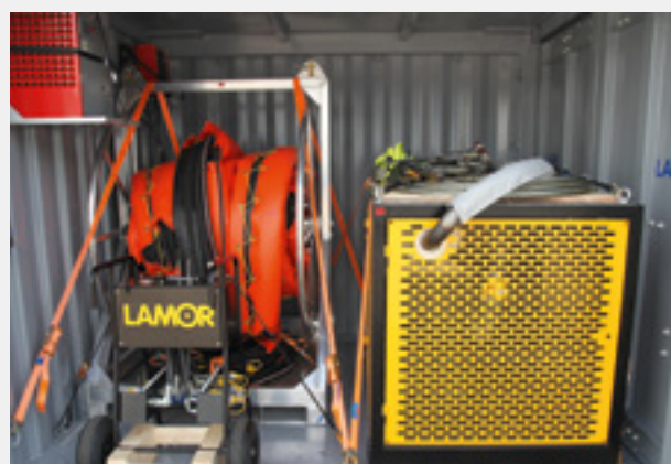
Solución en contenedor que incluye unidad de potencia, carrete de manguera y control hidráulico para skimmers
