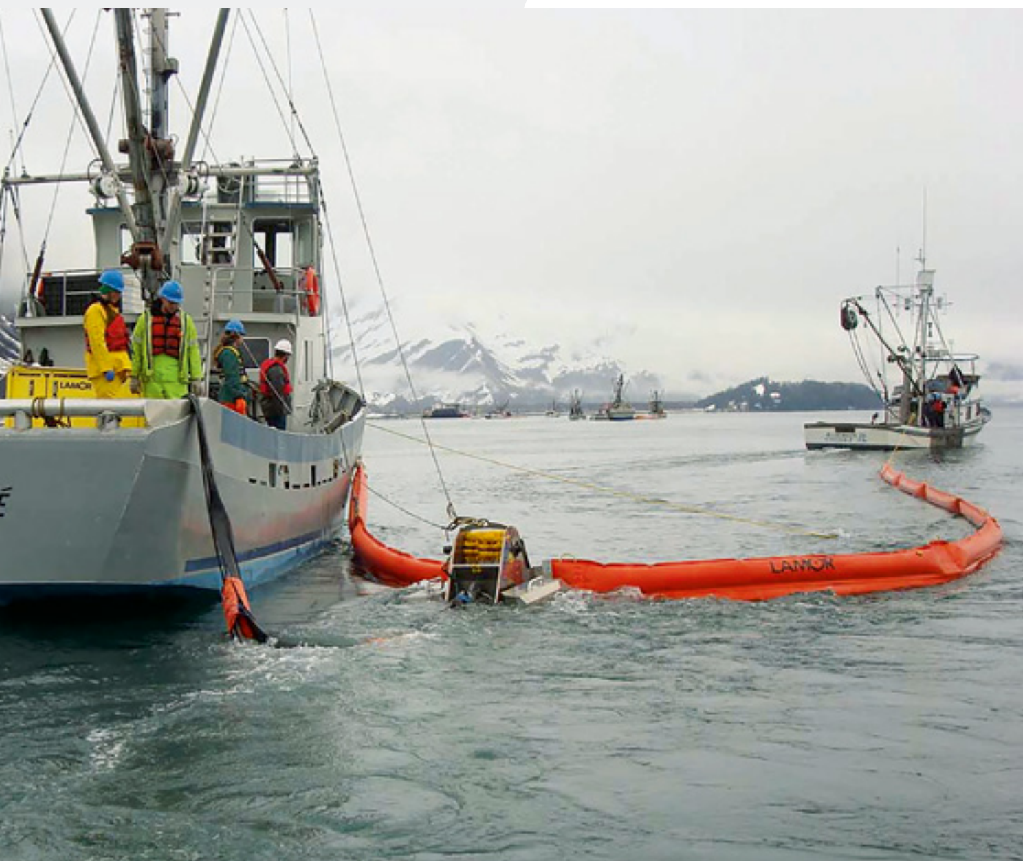
Multimax 50 (LAM 50), capacidad: 50 m 3 /h (220 gpm)
