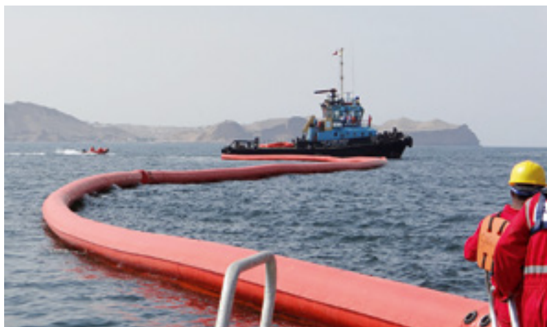
Barrera Uniboom X, altura: 1900-3000 mm (75-118 pulgadas)
