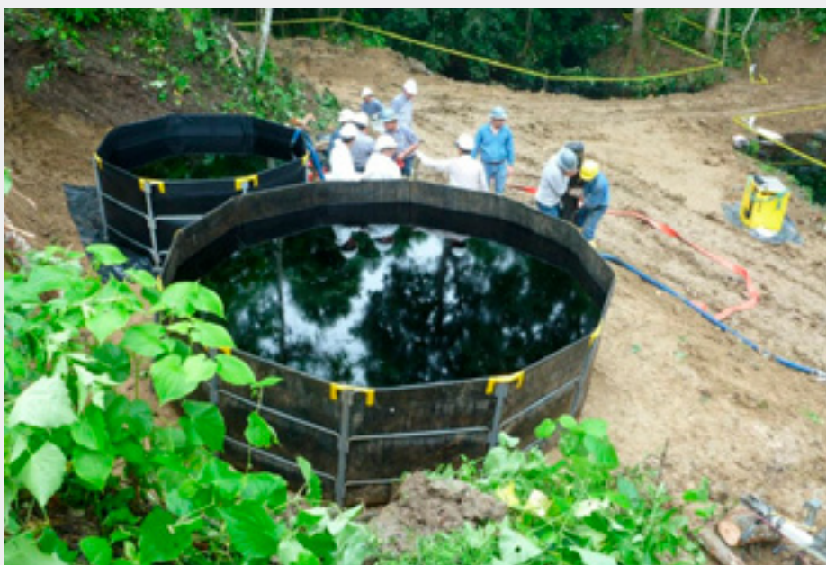
Tanque de almacenamiento de petróleo plegable, LPP 6 C 75 y skimmer Minimax 12
