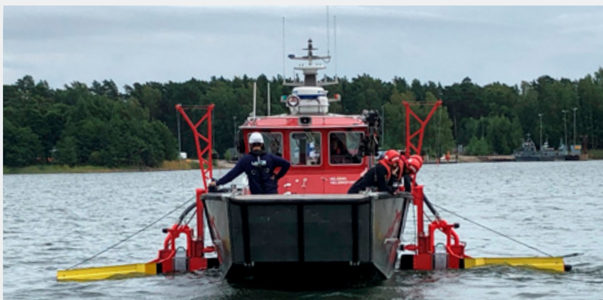
Minibagger / Sistema lateral de recolección de hidrocarburos. Capacidad: 10 m 3 /h (44 gpm)
