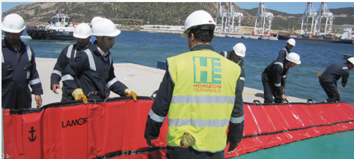
Barrera FOB, altura: 350-1500 mm (14-59 pulgadas)
