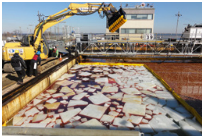
Skimmer de recuperación (LRB 150), capacidad: 115 m 3 /h (506 gpm)
