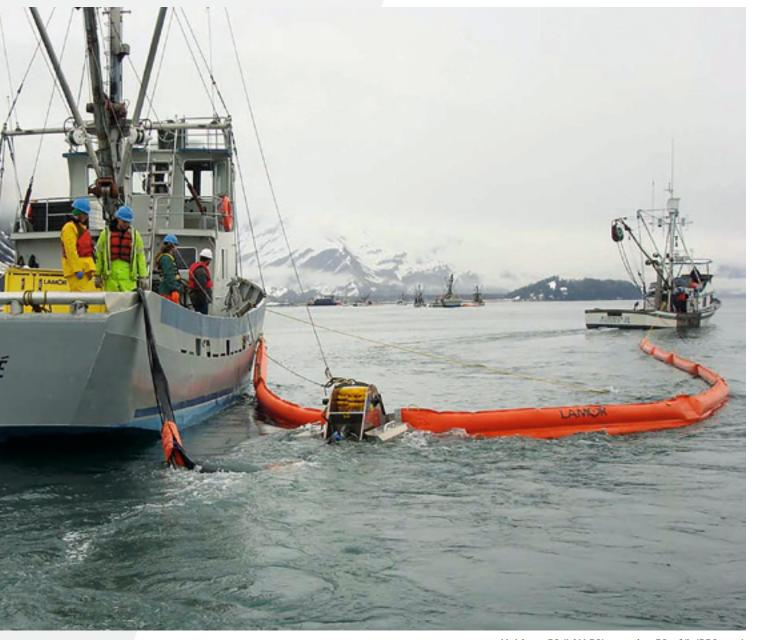
Multimax 50 (LAM 50), capacity: 50 m³/h (220 gpm)
